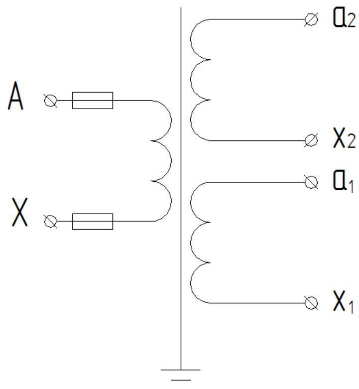
Рисунок Б.2 – Схемы электрические принципиальные для трансформаторов НОЛП-НТЗ-6 (10)
