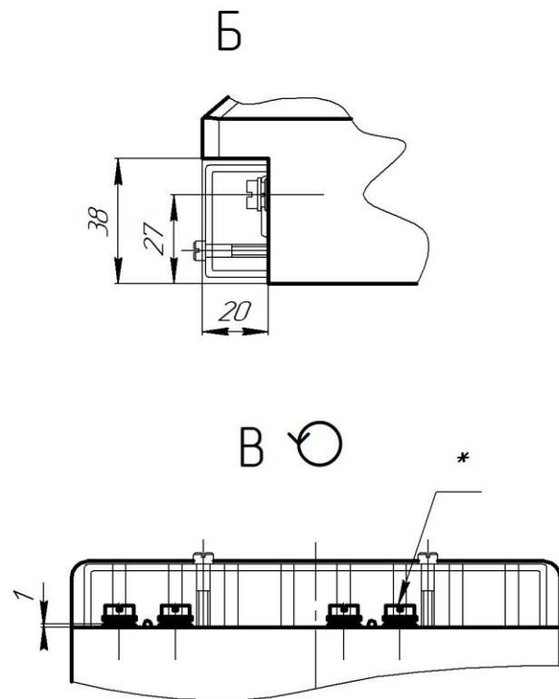
\* Для исполнений с меньшим числом вторичных обмоток отверстия несуществующих вторичных выводов заглушены.
