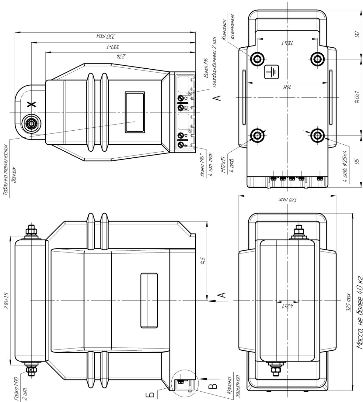
Рисунок А.4 – Габаритные, установочные, присоединительные размеры и масса трансформаторов НОЛП-НТЗ-6(10)-02
