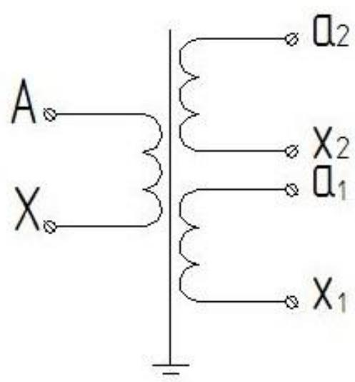
Рисунок Б.1 – Схемы электрические принципиальные для трансформаторов НОЛ-НТЗ-6 (10, 20, 35)
