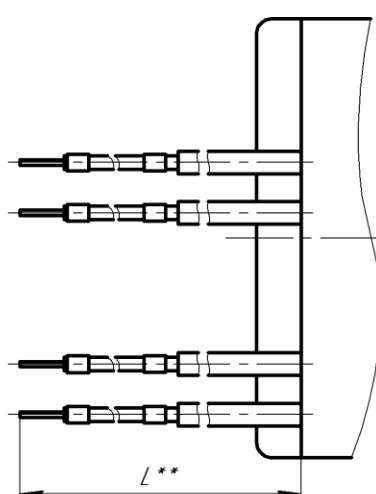
\* Для исполнений с меньшим числом вторичных обмоток отверстия несуществующих вторичных выводов заглушены.
