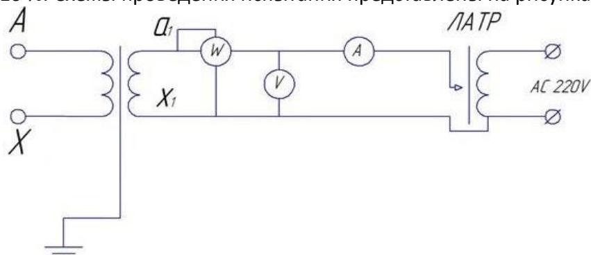
Рисунок 1 – Схема проведения испытания для трансформаторов с одной вторичной обмоткой
