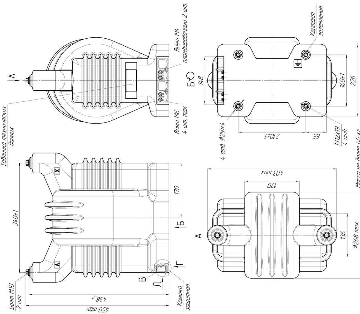
Рисунок А.8 – Габаритные, установочные, присоединительные размеры и масса трансформаторов НОЛ-НТЗ-35
