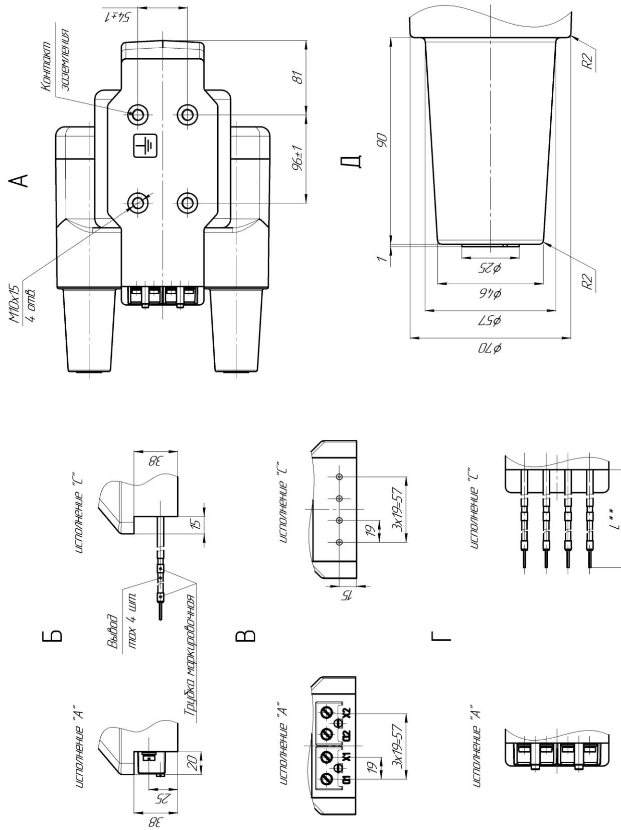
Рисунок А.6 – Габаритные, установочные и присоединительные размеры трансформаторов НОЛ-НТЗ-6(10)-03
