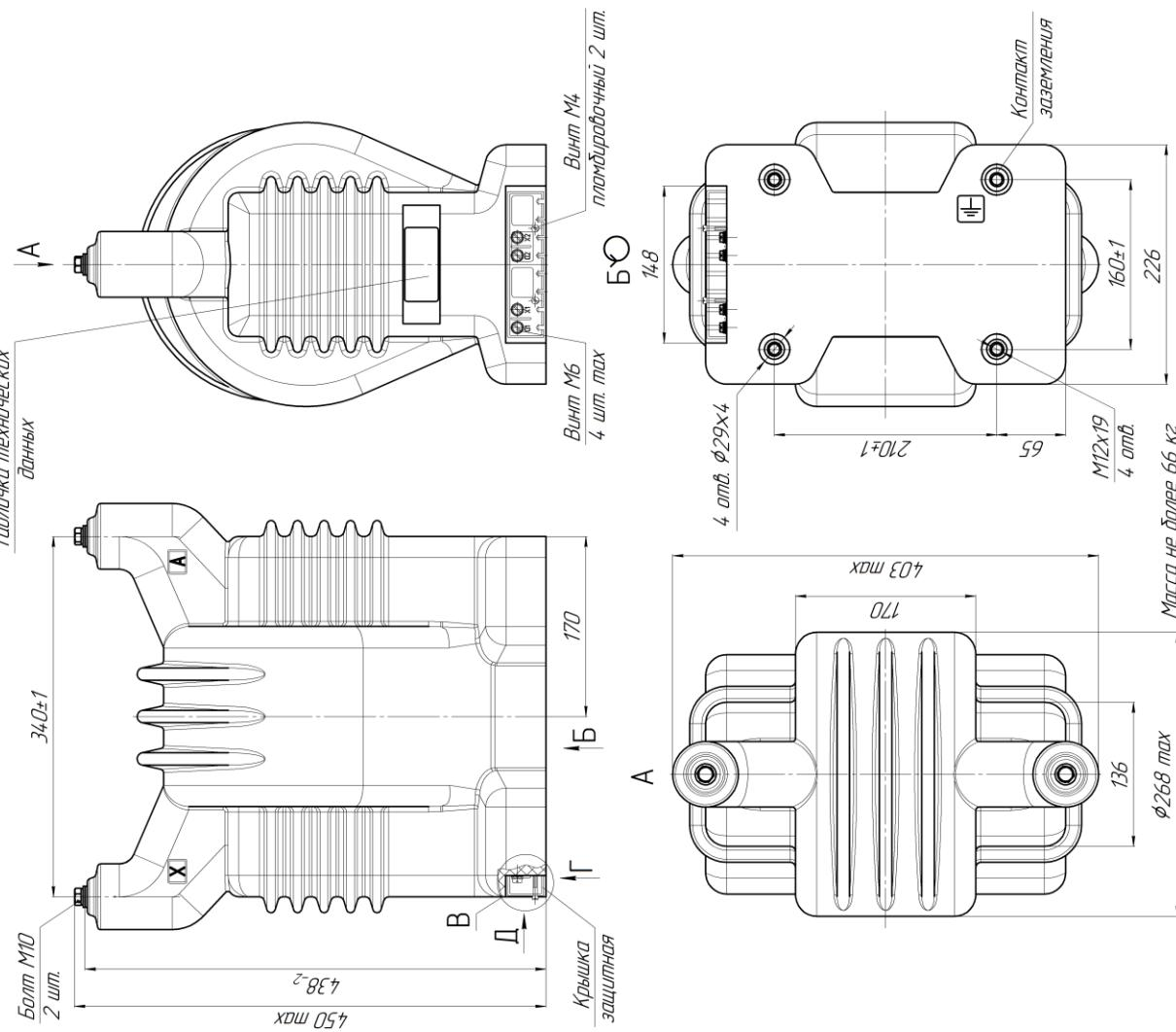
Рисунок А.9 – Габаритные, установочные, присоединительные размеры и масса трансформаторов НОЛ-НТЗ-35-01
