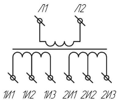
Рисунок Б.2 – Схема электрическая принципиальная для исполнений «К»
