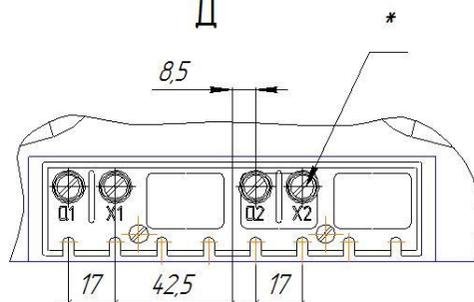
*\* – Для исполнений с меньшим числом вторичных обмоток отверстия несуществующих вторичных контактов заглушены.*
