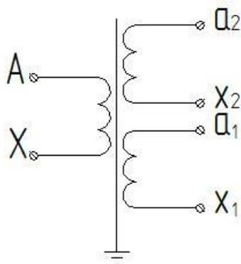
Рисунок Б.1 – Схемы электрические принципиальные трансформаторов
