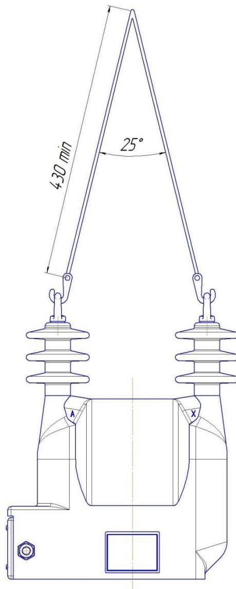
Рисунок Г.1 – Схема строповки трансформаторов ОЛ-НТ3-1,25/6(10)-IV
