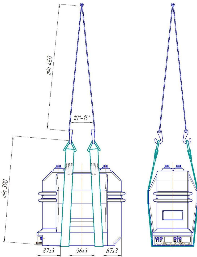
Рисунок В.1 – Схема строповки трансформаторов НОЛ-НТЗ-20
