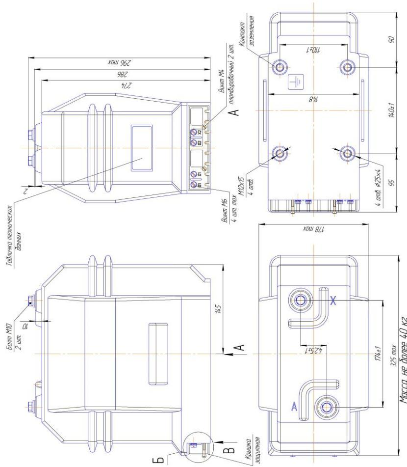
Рисунок А.1 – Габаритные, установочные, присоединительные размеры и масса трансформаторов НОЛ-НТЗ-20
