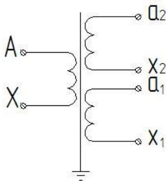
Рисунок Б.1 – Схемы электрические принципиальные трансформаторов НОЛ-НТЗ-20 все исполнения
