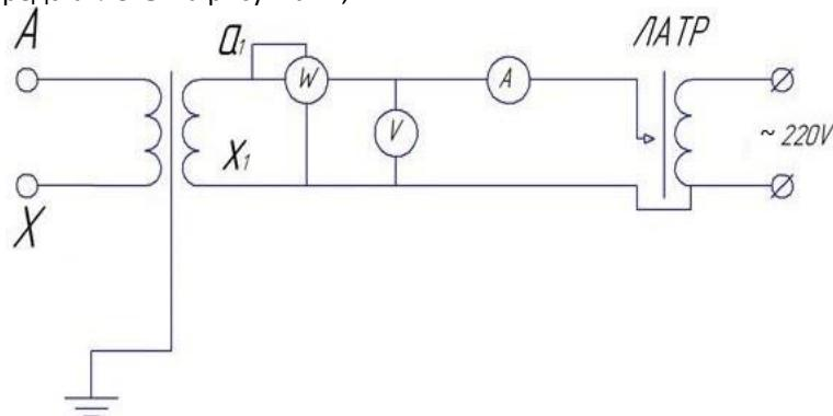
Рисунок 1 – Схема проведения испытания для трансформаторов с одной вторичной обмоткой
