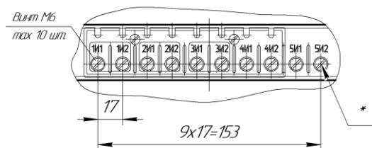
\* Для исполнений с меньшим числом вторичных обмоток отверстия несуществующих вторичных выводов заглушены;
