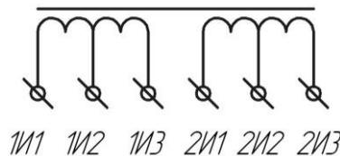
Рисунок Б.2 – Схема электрическая принципиальная для исполнений «К»
