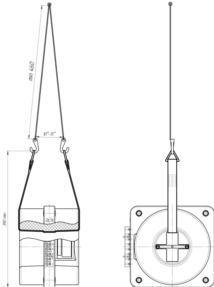
Рисунок В.1 – Схема строповки трансформаторов тока ТШЛ-НТЗ-10
