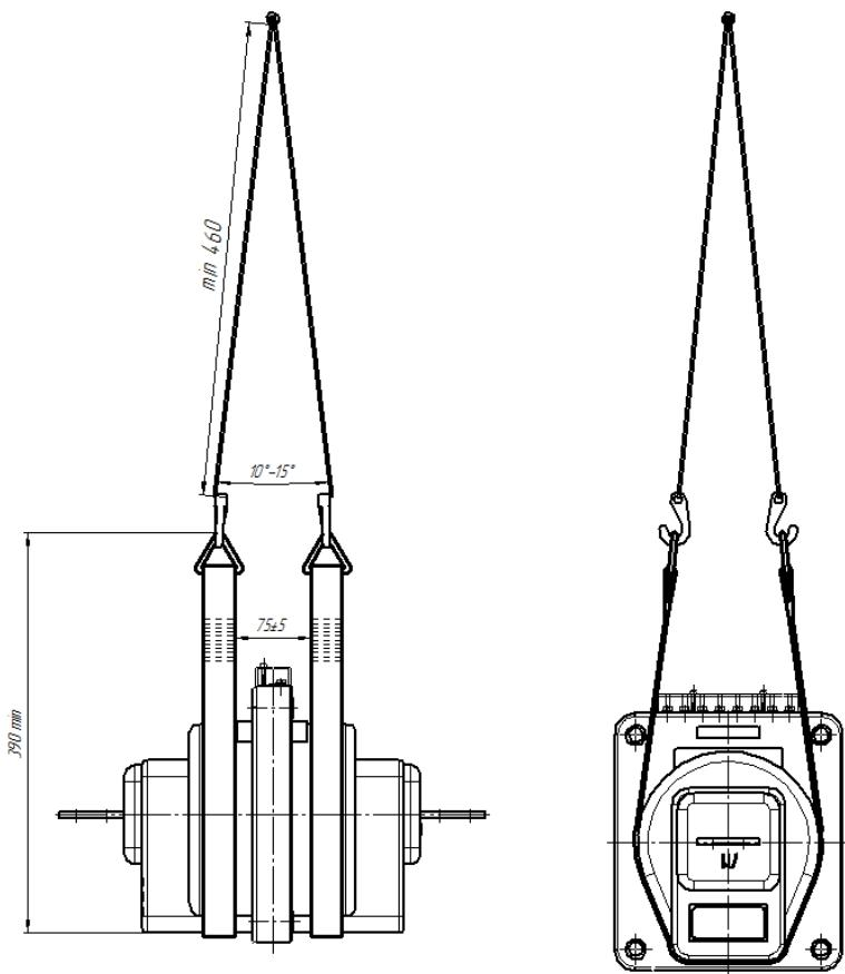
Рисунок В.1 – Схема строповки трансформаторов тока ТПЛ-НТЗ-10
