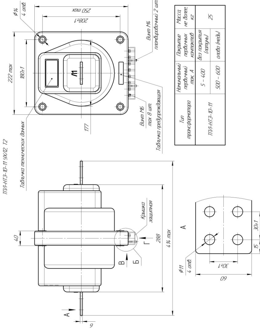
Рисунок А.1 – Габаритные, установочные, присоединительные размеры и масса трансформаторов ТПЛ-НТЗ-10-11
