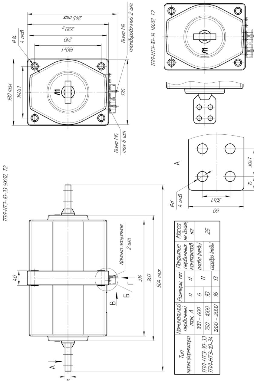
Рисунок А.12 – Габаритные, установочные, присоединительные размеры и масса трансформаторов ТПЛ-НТЗ-10-33, -34
