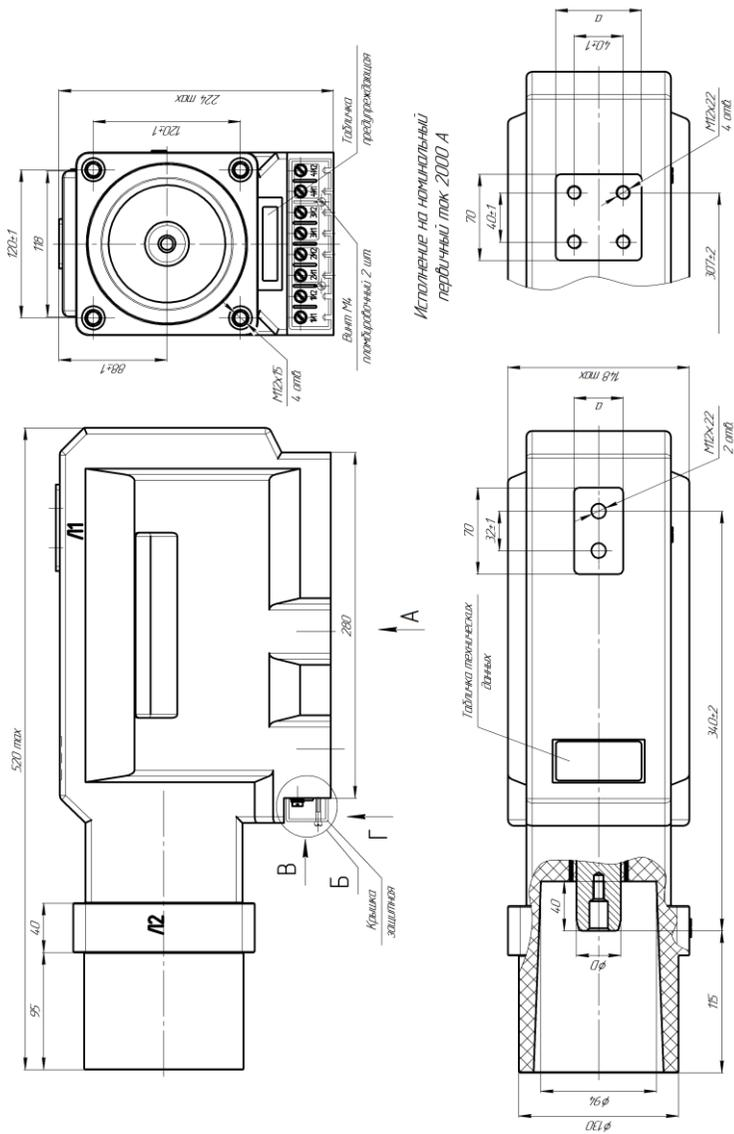
Рисунок А.27 — Габаритные, установочные, присоединительные размеры трансформаторов ТОЛ-НТЗ-10-61
