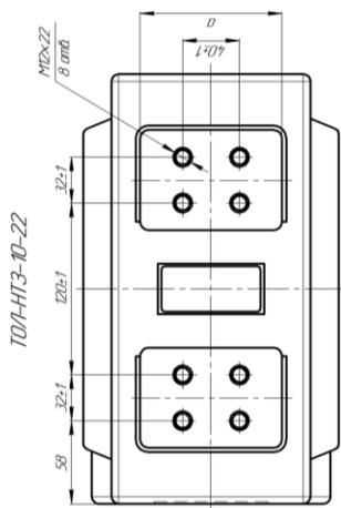
Рисунок А.17 – Габаритные, установочные, присоединительные размеры трансформаторов ТОЛ-НТЗ-10-21,-22,-23
