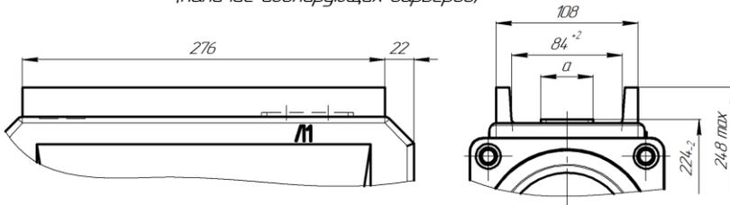
Рисунок А.28 – Установочные, присоединительные размеры и масса трансформаторов ТОЛ-НТЗ-10-61
