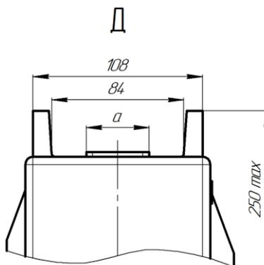
Рисунок А.2 – Габаритные и присоединительные размеры трансформаторов ТОЛ-НТЗ-10-01 исполнения Б
