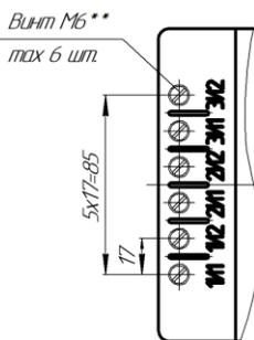
Рисунок А.9 – Варианты исполнения вторичных выводов ТОЛ-НТЗ-10-10,-11,-12,-13
