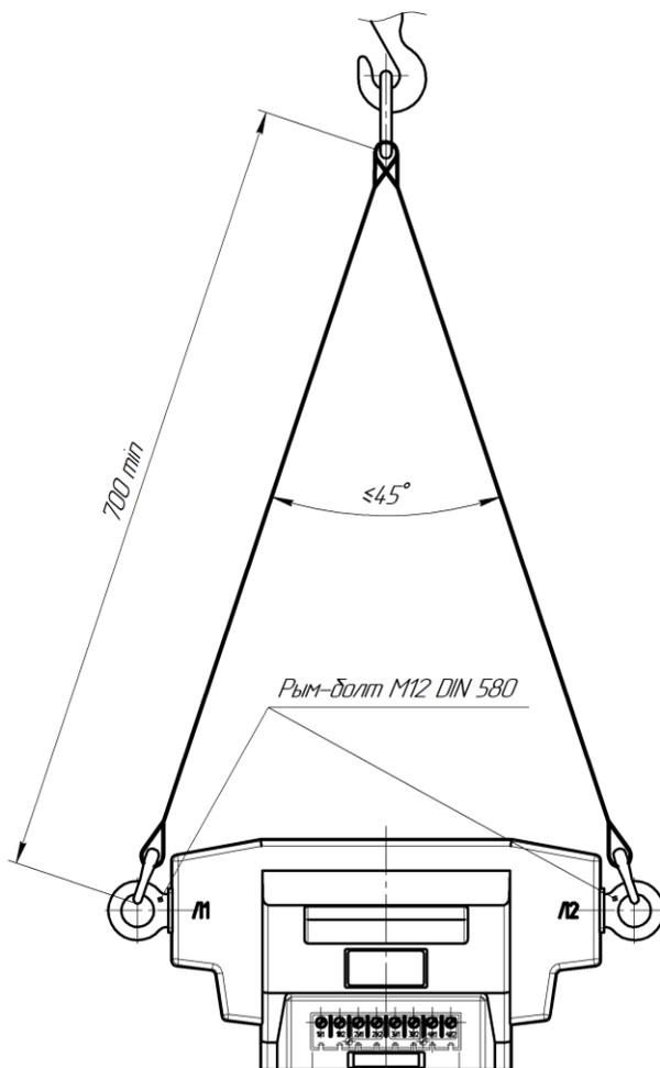
Рисунок Г.3 – Схема строповки трансформаторов ТЛ-НТЗ-10-41
