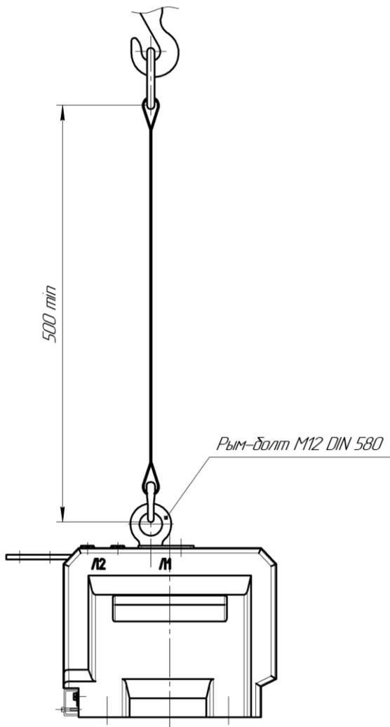
Рисунок Г.2 – Схема строповки трансформаторов ТОЛ-НТЗ-10-31
