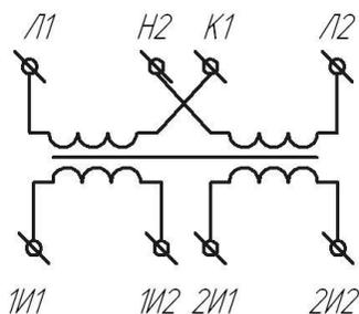
Рисунок Б.2 – Схема электрическая принципиальная для исполнений «П»
