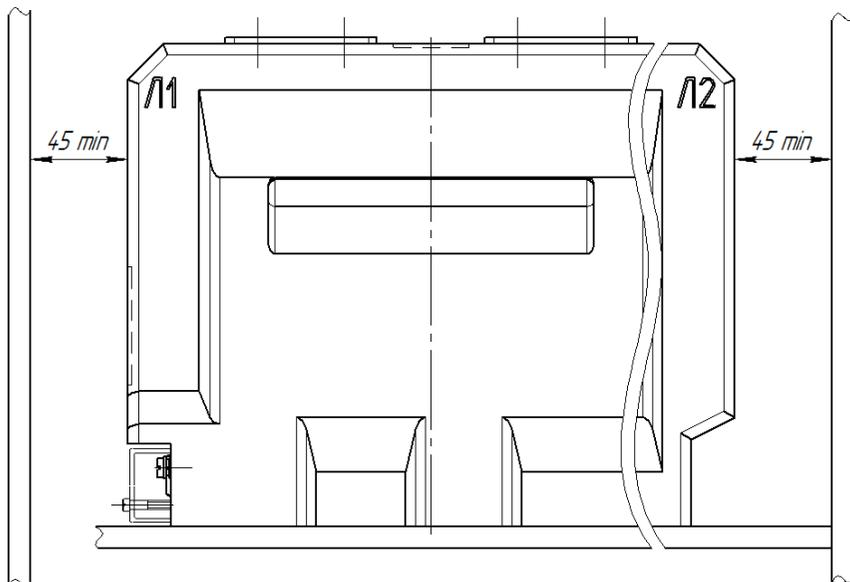
Рисунок В.1 – Монтаж трансформаторов тока ТОЛ-НТЗ-10
