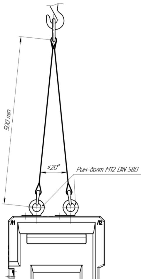
Рисунок Г.1 – Схема строповки трансформаторов
