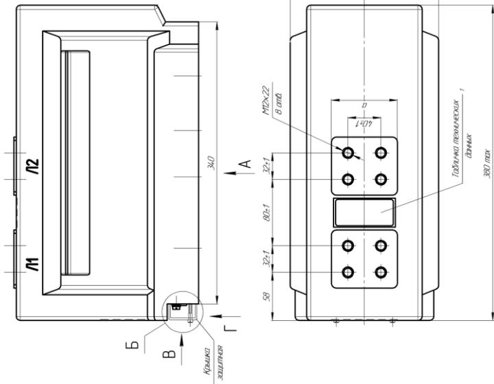
Рисунок А.16 – Габаритные, установочные, присоединительные размеры трансформаторов ТОЛ-НТЗ-10-21,-22,-23
