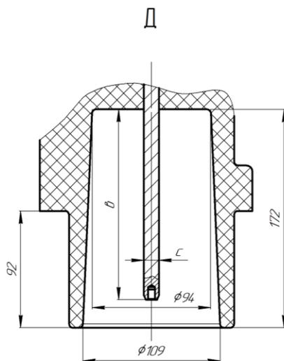
Рисунок А.25 – Установочные и присоединительные размеры трансформаторов ТОЛ-НТЗ-10-51
