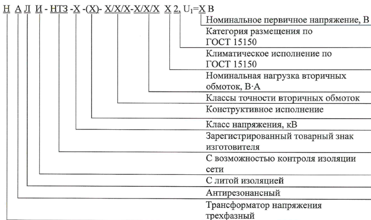
Рисунок 1 - Структура условного обозначения трансформатора
